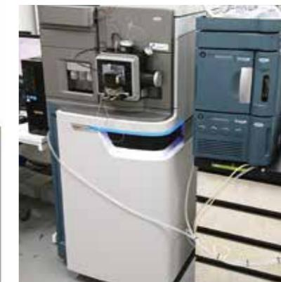
Native MSの測定原理。サンプルのエレクトロスプレーイオン化法によるソフトなイオン化と装置内の真空中度を徐々に上げることによる穏和な脱溶媒和、そして揮発性緩衝液の使用により分子複合体を維持したままの質量分析を可能とする。
