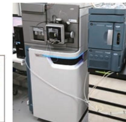
Native MSの測定原理。サンプルのエレクトロスプレーイオン化法によるイオン化と装置内の真空度を徐々に上げることによる穏和な脱溶媒和、そして揮発性緩衝液の使用により分子複合体を維持したままの質量分析を可能とする。
